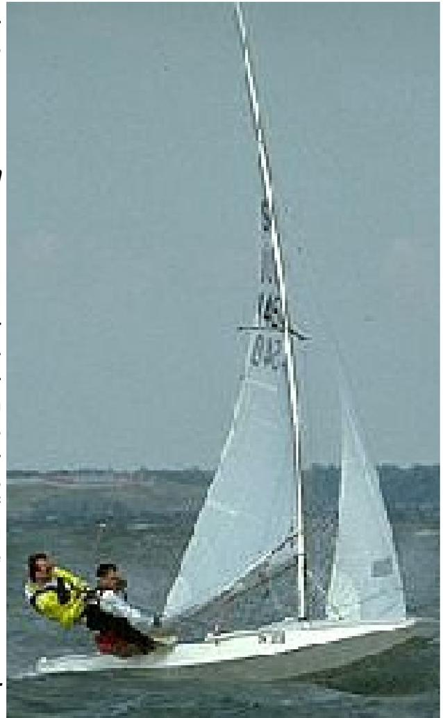
So wird sich das Boot gut auf ebenem Kiel halten lassen. Bis etwas über 30 Knoten (um 7 Bft.) sollte das machbar sein. Fühlt sich der ganze Starkwindgrundtrimm erst mal etwa richtig an, können die einzelnen Trimmelemente noch angepasst werden: Feintrimm von Baumniederholer, Mastkontroller und Fockholepunkten.
