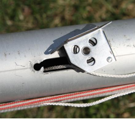
Der Steg zwischen dem Loch für den Block und demjenigen für die Niete ist gebrochen und verkrümmt! Wie kann hier die offensichtlich unter hohem Zug stehende Niete je wieder Halt finden?
