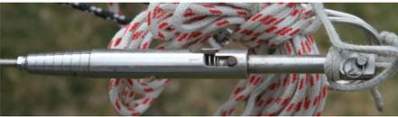
Die *Wantenversteller* selber: Jeden Winter werden sie geöffnet, damit Rohr und Feder innen gut von Rost und Salz gereinigt werden können, und dann mit etwas Waffenöl geschmiert.
