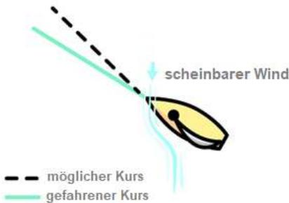
Abb. 1: Segel brauchen ungestörte Anströmung auf der Leeseite, um optimalen Vortrieb zu produzieren. Zu dichte Schoten klemmen diese ab. Darum: Fiere um laufen zu lassen!
