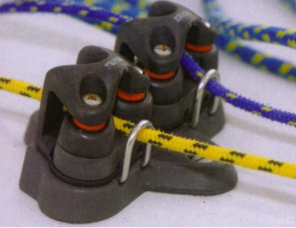
Für Curry-Klemmen gilt dasselbe wie für Blöcke, sowohl in Bezug auf deren Befestigungsort, Anpassung an Schootdicke, wie auch deren Unterhalt mit Spülung und Schmierung. Clamcleats müssen auf Haltekraft getestet werden, denn sie neigen zum durchrutschen Lassen bei längerem Gebrauch. Ganz wichtig: Hitze macht die Zähne stumpf, also zieh die Leinen nach Möglichkeit nicht meterweise durch die Backen, sondern erst zum Belegen.
