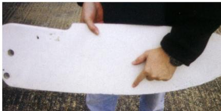
Reparatur: Kleinere Gelcoat-Reparaturen können durchaus selber durchgeführt werden! Wenn Du's noch nie gemacht hast, folge einfach genau der Beschreibung auf der Packung, und beachte, dass die Umgebung nicht zu heiss, zu kalt oder zu feucht ist. (Also im Winter nur in geheiztem Raum! Zwischen 10 und 20°C).
