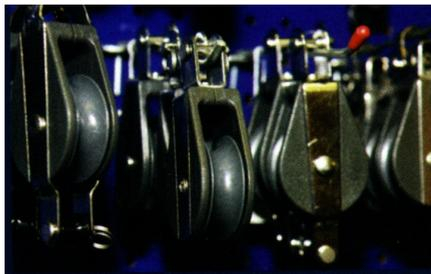
Ein zentraler Faktor ist die korrekte Befestigung an dem Ort, wo der Block für die Umlenkung auch sein muss. Jede Abweichung erhöht die Reibung und entsprechend die Abnutzung von Block und Schoot, von der Crew gar nicht zu reden! Möglicherweise ist die Fixierung des Blocks mittels Leine einem Schäkel vorzuziehen.
